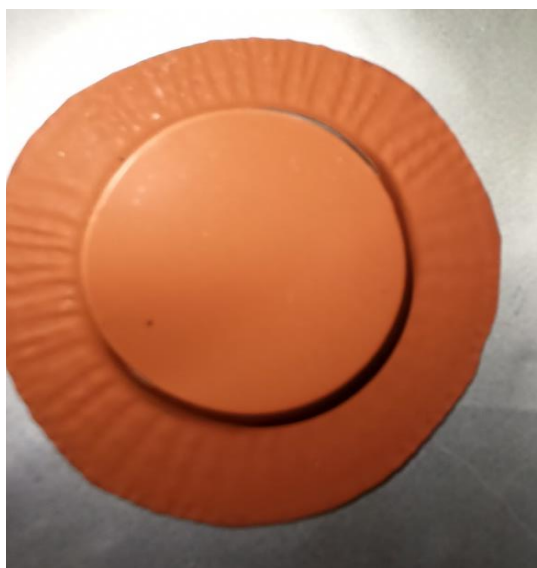
а) форма фланца при вытяжке полимерным инструментом
