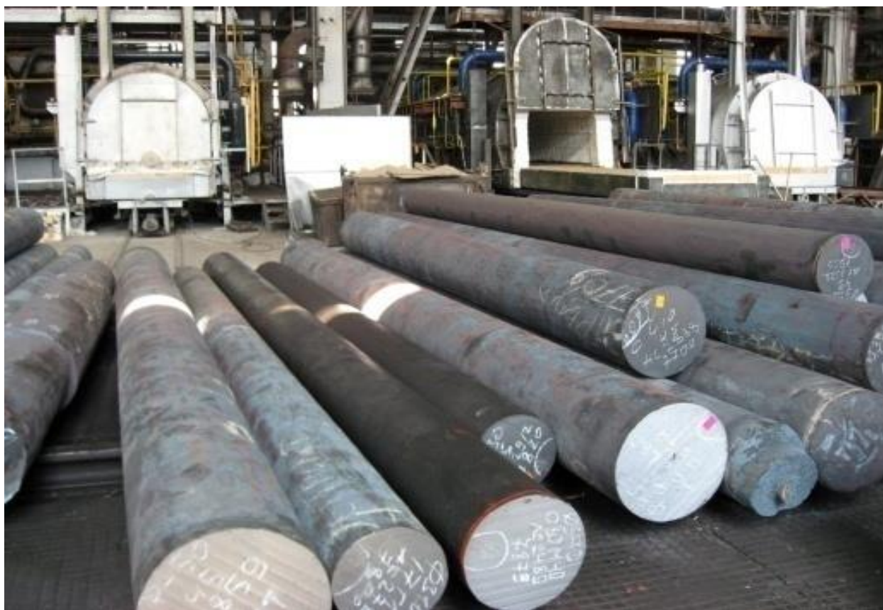
Рисунок 2. Поковки круглого сечения, полученные в 4-х бойковом ковочном устройстве
