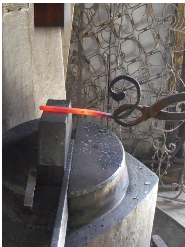
Фото 8-9. Восстановление декоративных и соединительных элементов ограды Фото из архива авторов
