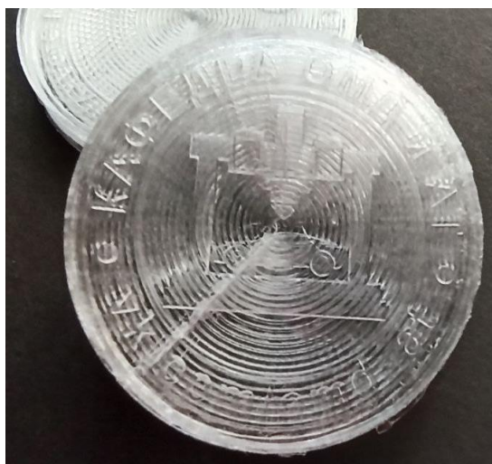
а) отпечаток на заготовке из пластика ПЭТГ
