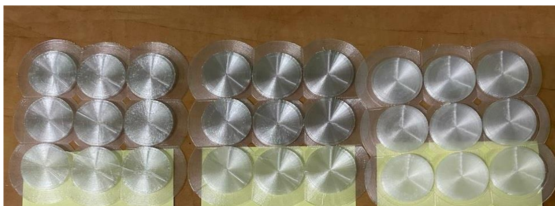
в) заготовки из пластика ПЭТГ после 3D-печати до выполнения чеканки
