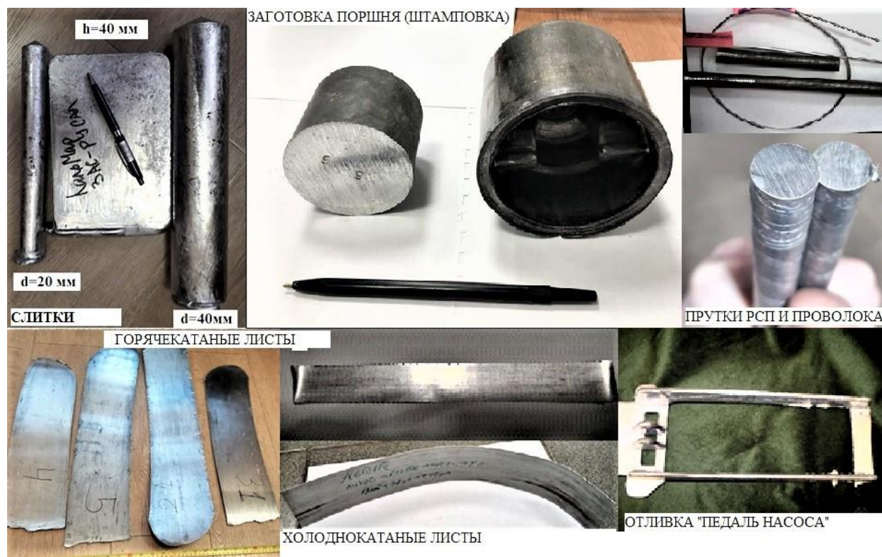
Рисунок 9. Полуфабрикаты, получаемые из новых алюминий-кальциевых сплавов (литые и деформированные)
