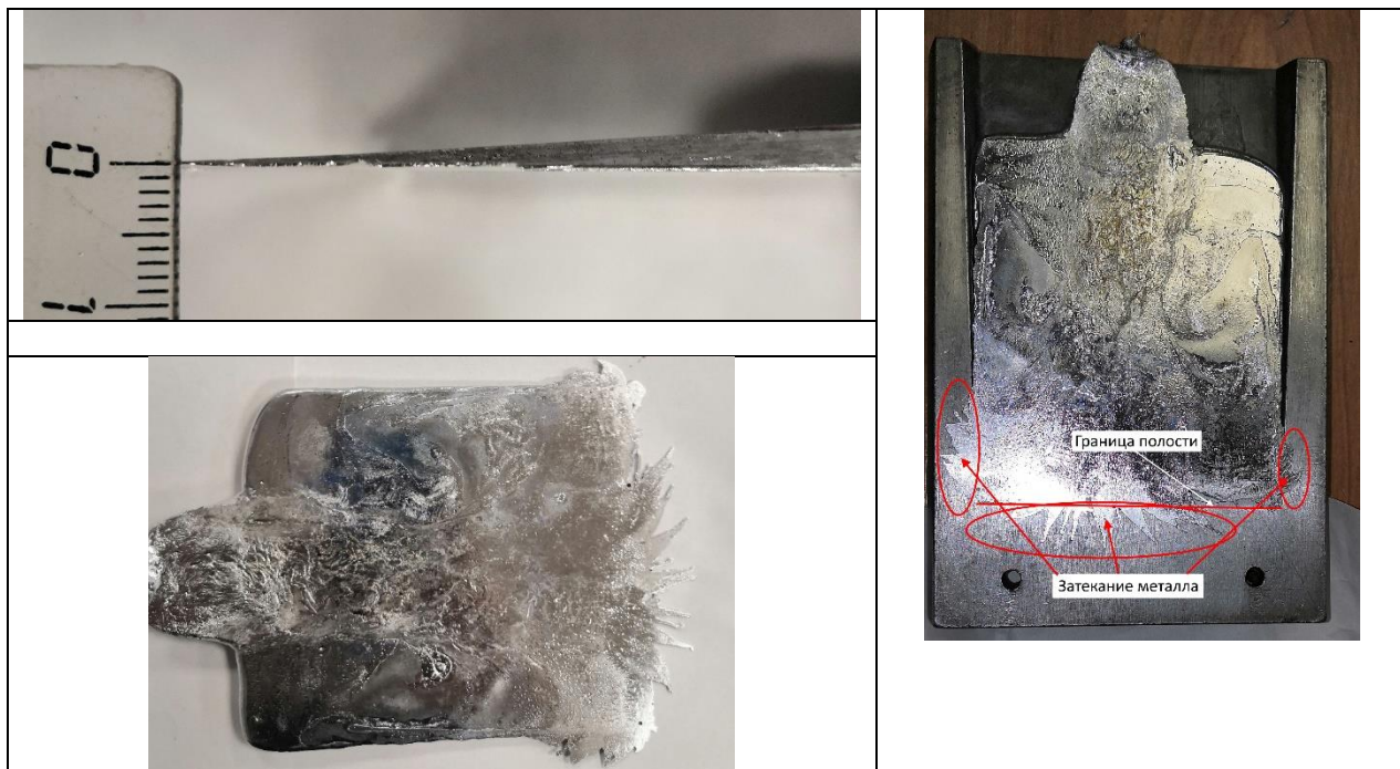
Рисунок 12. Полученная отливка клиновидной пробы из сплава Al-7%Ca [3]
