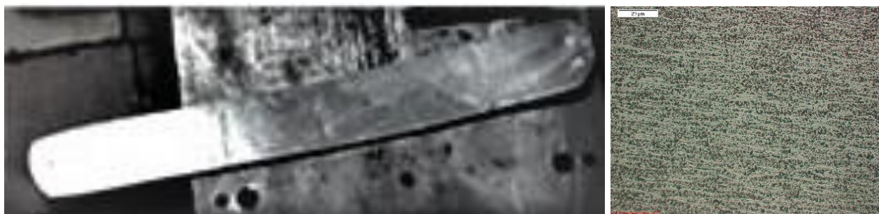
а б Рисунок 6. а – образец проката из сплава системы Al-Ca-Cu; б - структура сплава системы Al-Ca-Cu (прокат)
