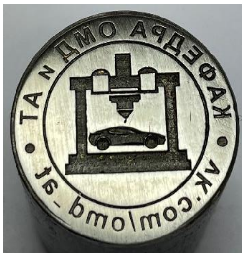
б) формообразующая поверхность верхнего инструмента
